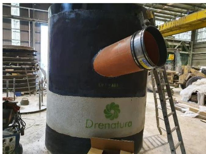
**Fig. 11.** Acometida tangencial acabada, solo requiere la unión del tubo de entrada con el manguito abrazadera provisto.
