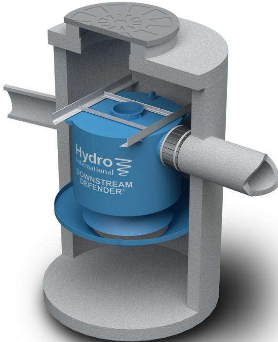
El separador hidrodinámico Downstream Defender® es un dispositivo avanzado de tratamiento de las aguas pluviales capaz de remover residuos flotantes, sólidos sedimentables e hidrocarburos en un solo proceso.
