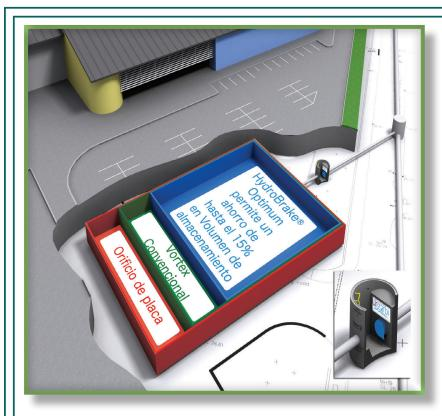
El rendimiento hidráulico superior de HBO permite reducir los requerimientos del volumen de almacenamiento de un proyecto de regulación hasta un 15% más que usando las válvulas vortex de otros competidores.
